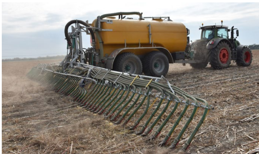
Obrázok 8 Povrchová aplikácia hnojovice pätkovým aplikátorom (foto: Ing. Nerád)
